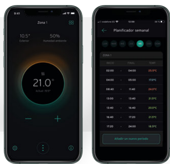
sensROOM VRT 51f + módulo myVAILLANT El módulo myVAILLANT actúa como receptor inalámbrico del sensoROOM VRT 51f Imprescindible utilizar los dos juntos sensROOM VRT 51f + myVAILLANT VR 940f se suministran juntos en el mismo embalaje
