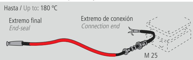
Kit conexión M25 + final / M25 connection + end kit AKO-70194 (Sólo para / Only for AKO-52341)
